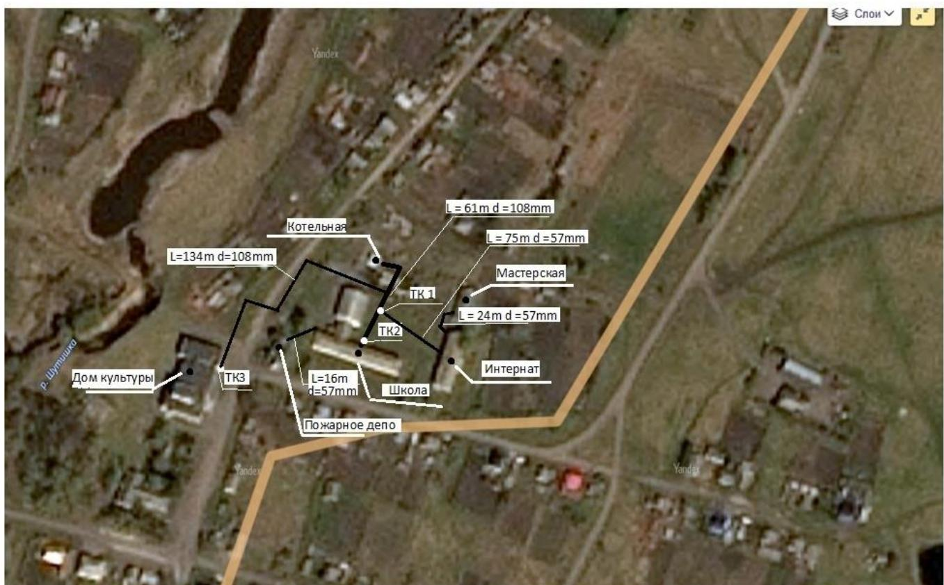
**3.3 Параметры тепловых сетей, включая год начала эксплуатации, тип изоляции, тип компенсирующих устройств, тип прокладки, краткую характеристику грунтов в местах прокладки с выделением наименее**
